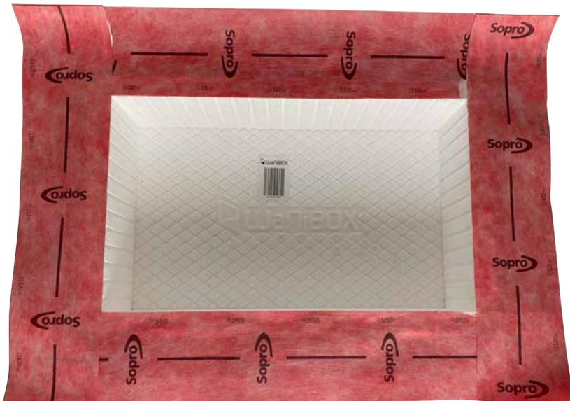
Aus Sopro AEB® Dichtband 641 werden Bänder abgelängt und unter Verwendung von Sopro Racofix® Montagekleber RMK 818 und flächig und dicht auf der Wandung der WaNiBOX verklebt.
